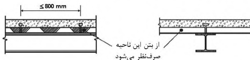
شکل ۱۰-۲-۸-۸: عرشه فولادی که کنگره‌های آن عمود بر محور طولی تیر است
