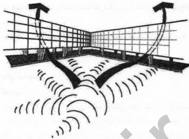
شکل ۲۱-۲-۵- تخلیه موج انفجار از پیلوت باز
